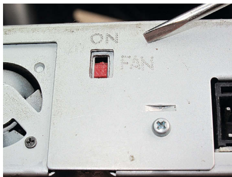
Управление вентилятором «мозгов» Alpine
