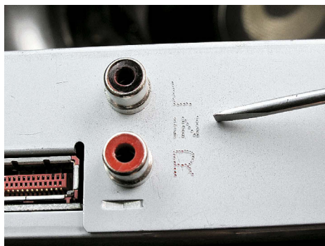
Добавленные RCA-входы для совместной работы двух головных устройств
