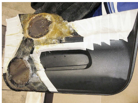
Формование подиумов для НЧ и СЧ. Одного калибра...
